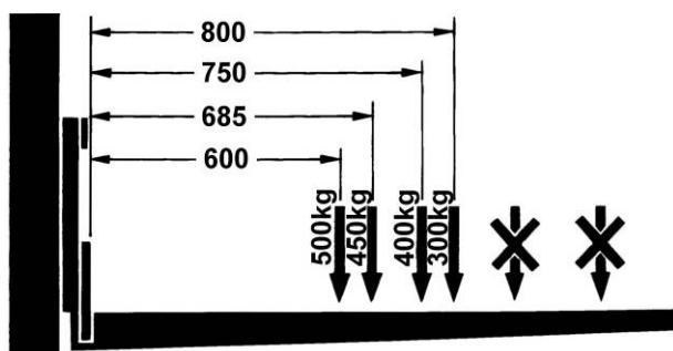
La charge doit être répartie uniformément sur les deux fourches.
